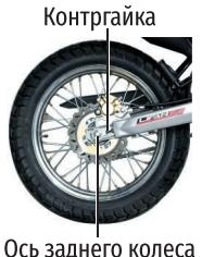
**Примечание.** Монтаж производится в порядке, обратном демонтажу. Момент затяжки гайки оси заднего колеса:  $90\pm10$  Нм.
